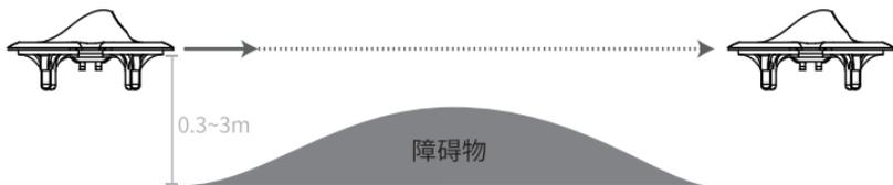
注1: 在使用普通模式飞行时,尽量选择室内或无风室外环境,飞行高度控制在0.3m-3m之间,室外飞行高度尽量不超过3m。更详细的说明和飞行模式切换请参考说明书3.5和4.1。
