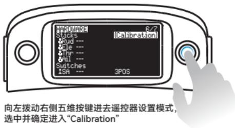
向左拨动右侧五维按键进去遥控器设置模式，选中并确定进入“Calibration”
