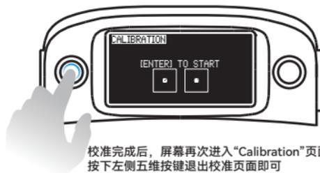
校准完成后，屏幕再次进入“Calibration”页面，按下左侧五维按键退出校准页面即可
