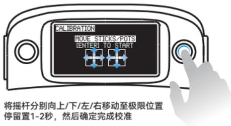
将摇杆分别向上/下/左/右移动至极限位置停留置1-2秒，然后确定完成校准
