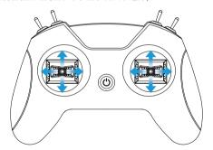
再次短按电源键,此时遥控器将记录摇杆的边界,并完成校准。 注意:
