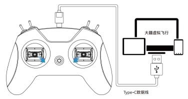
● 同时将左侧摇杆拨到右下角,右侧摇杆拨到左下角,此时使用Type-C数据线将遥控器
