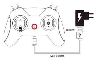
电池充满,可以连续使用 8小时左右;电池充满,关机放置,可以保证 30天电池电量仍保持在80%左右。
